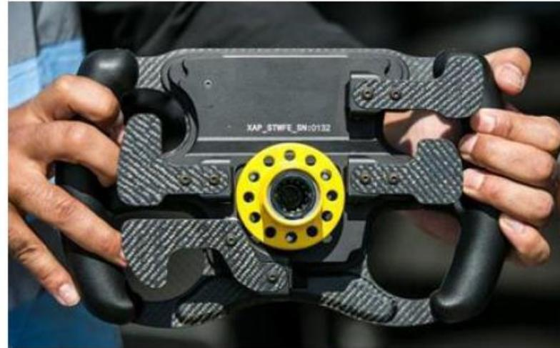
Comment enlever un volant ? Faire coulisser la bague (jaune dans l'exemple) et tirer sur le volant. La remise en place se fait tout simplement en enfonçant le volant sur son axe (il se clipse).
